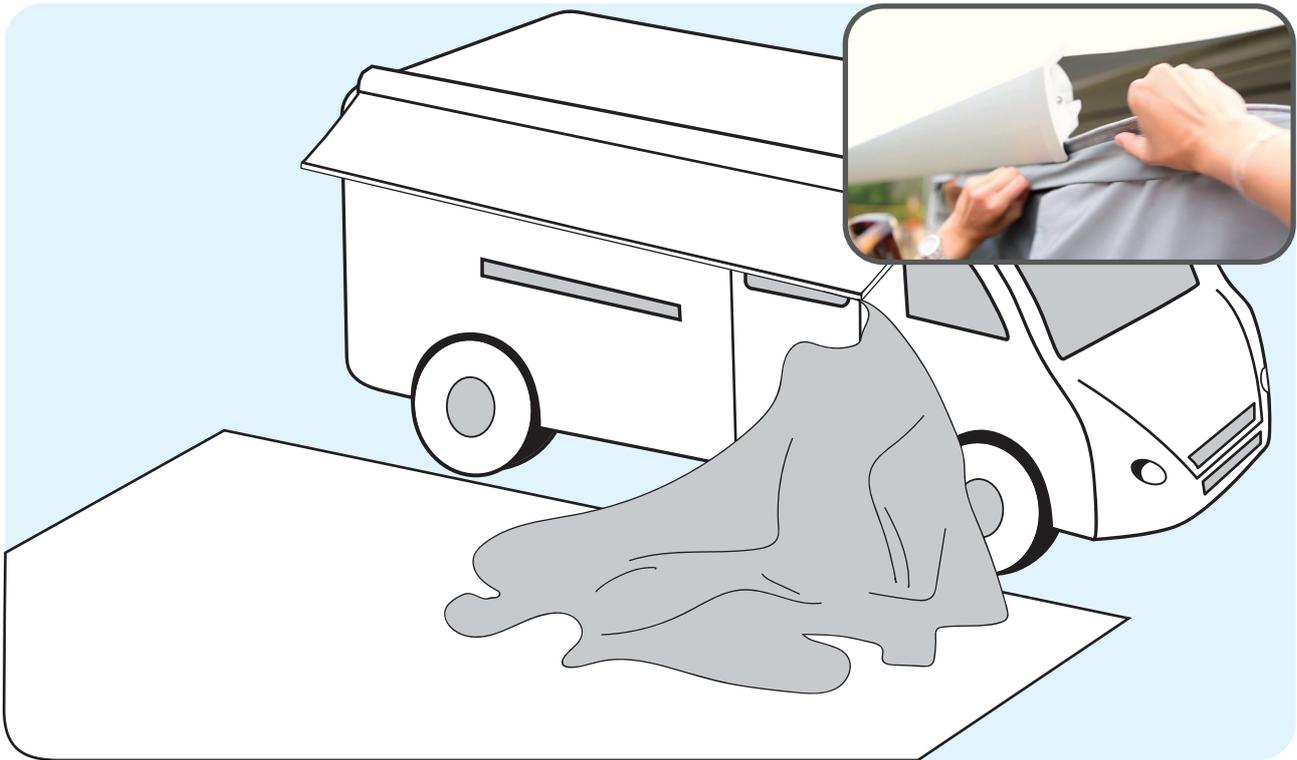
Das Vorzelt ist mit dem passenden Keder für die Markise ausgestattet. Bitte ziehen Sie Ihr Zelt in die passende Kederschiene ein.
