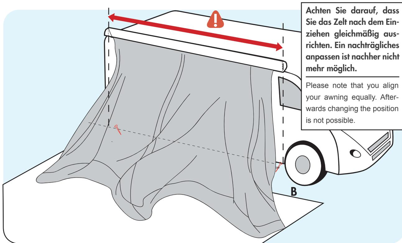
Achten Sie darauf, dass Sie das Zelt nach dem Einziehen gleichmäßig ausrichten. Ein nachträgliches anpassen ist nachher nicht mehr möglich.
