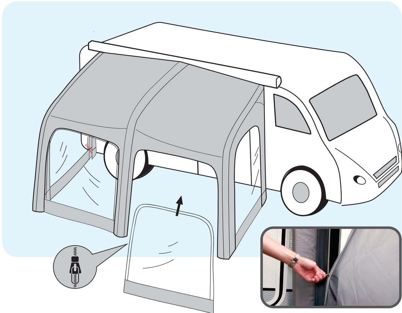
**Bei Bedarf Seiten und Frontwände einziehen**
