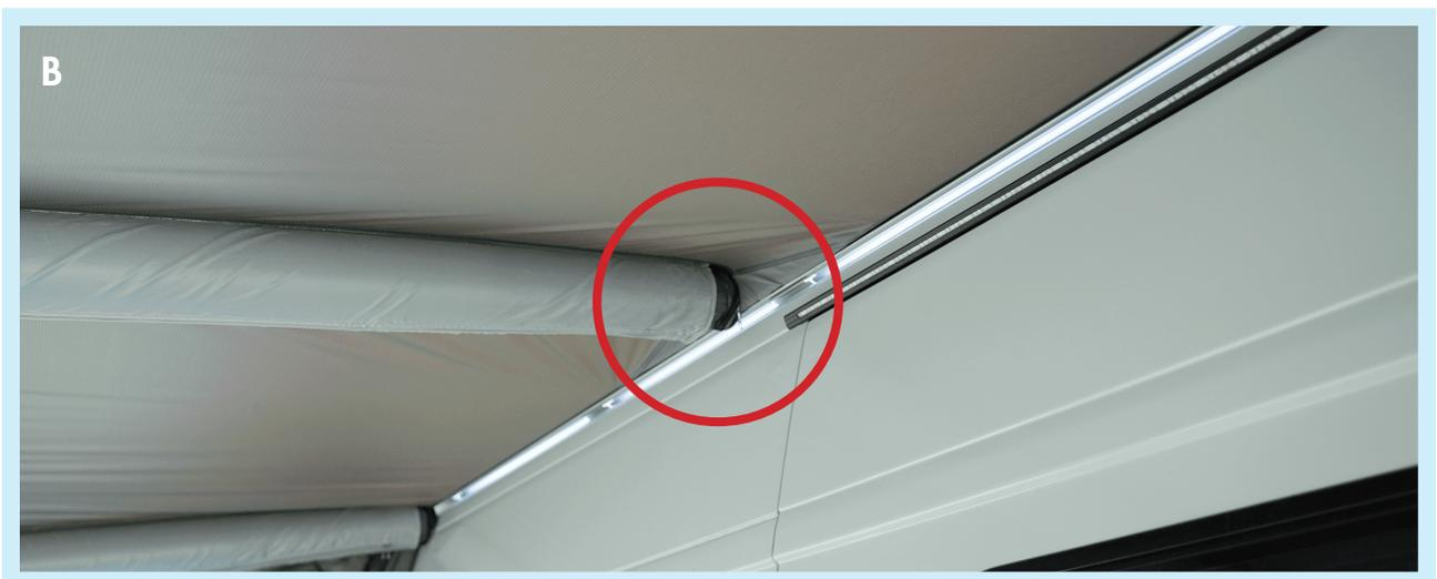
**Bitte prüfen Sie, ob der mittlere Luftschlauch richtig auf die Markise sitzt, so stört der Luftschlauch die Schiebetür nicht. Der Luftschlauch sollte von innen so wie die Abbildung B aussehen.**
