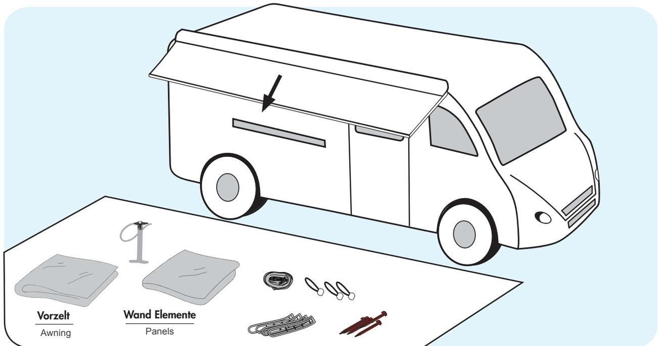
**Entnehmen Sie Vorzelt und Zubehör aus dem Packsack. Überprüfen Sie alles auf Vollständigkeit. Je nach Anbauhöhe und Art der Markise können Sie nun die Markise soweit ausfahren, dass Sie in der Lage sind das Zelt in die Kederschiene einzuführen.**
